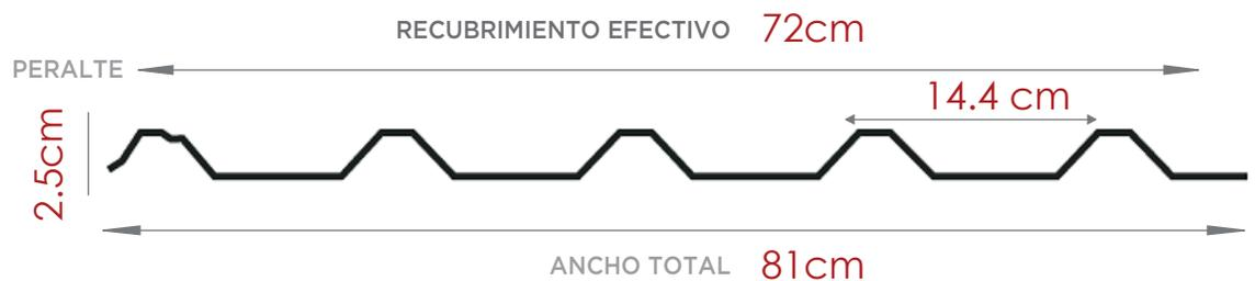
Para evitar filtraciones, así como ayudar al funcionamiento como diafragma es importante efectuar un cosido en el traslape longitudinal.
